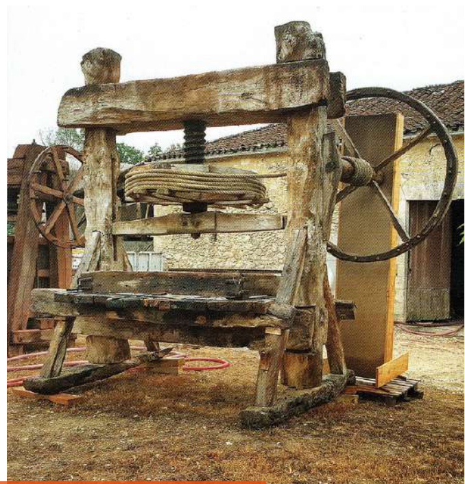
Pressoir du XVIe, ossature en chêne, vis en cormier
